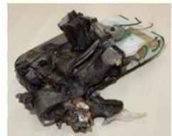
処理施設内で発火した充電式電池
